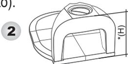
Instale a peça refratária da boca do forno encostando-a no rebaixo apropriado existente na base do forno, rejuntando com a massa refratária que acompanhou o forno
